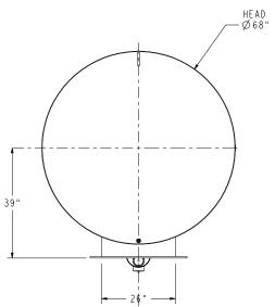
— 230 ° — **-**26" OUTLET 26 IN FLANGE— DRILLED TO ANSI #150 —— 27" — -INLET 26 IN FLANGE DRILLED TO ANSI #150
